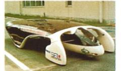
Im Interesse der Zukunft werden bei Mazda intensiv die Möglichkeiten alternativer Treibstoffe und Antriebe erforscht. Forschungen laufen u.a. mit Flüssiggas, Wasserstoff, Elektromotoren und Solarenergie. Ein eindrucksvolles Beispiel: das von Mazda entwickelte Flexible Fuel Vehicle (FFV). Sein Magergemischmotor läuft wahlweise mit herkömmlichem Benzin und dem sauber verbrennenden Methanol.
