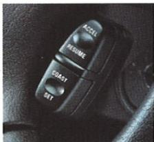
Wertvolle Unterstützung auf langen Strecken: der automatische Geschwindigkeitsregler im GLE und 2.5i V6.
