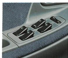
Sicherheitsorientierte Mazda-Technik: Die elektrisch betätigten Fensterheber schließen erst, wenn die Schalter angehoben werden.
